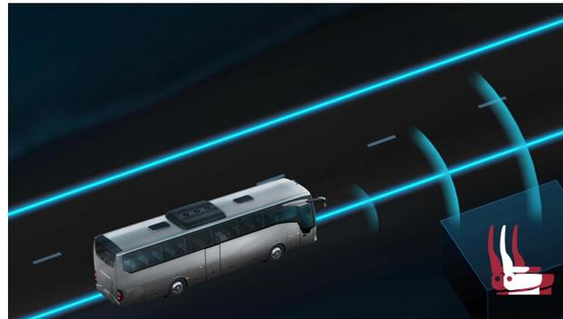
Der Spur-Assistent SPA erkennt, wenn das Fahrzeug ungewollt die markierte Spur verlässt. Überfährt es die Markierungslinien, wird der Fahrer durch ein deutliches Vibrieren am Fahrersitz gewarnt.
