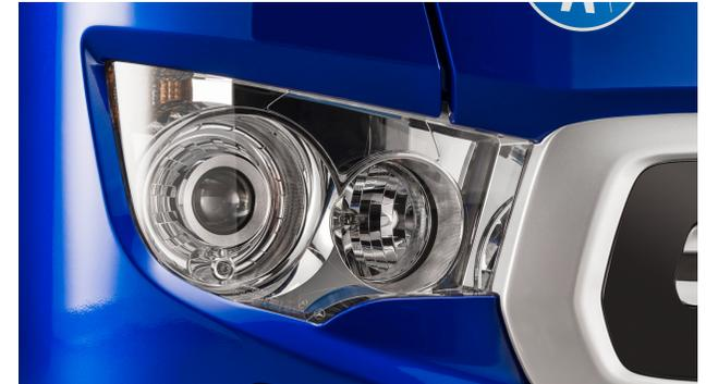
Bi-Xenon-Scheinwerfer bedeuten im Vergleich mit Halogenscheinwerfern eine bessere Ausleuchtung der Fahrbahn bei weniger Energieverbrauch und längerer Lebensdauer.
